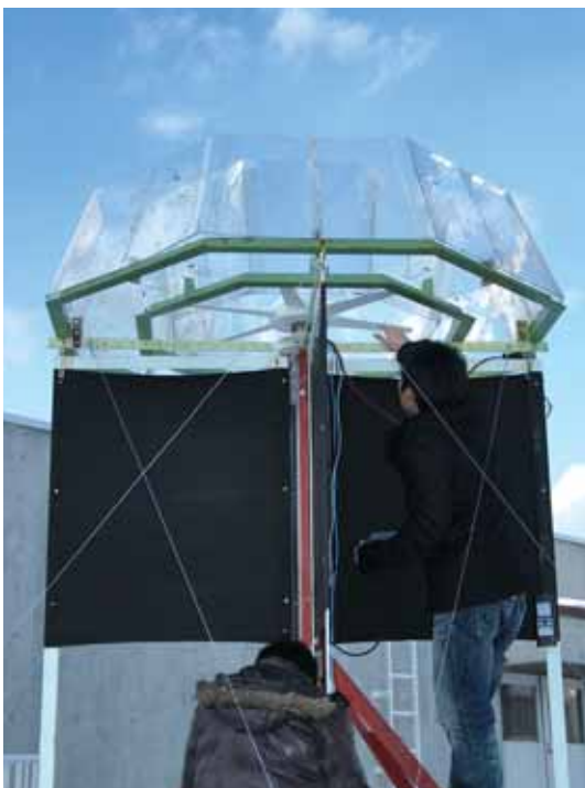
北見工大で開発中の集風塔型風車
