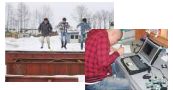
構造劣化度の診断
