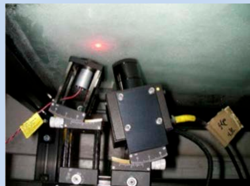
積雪によるレーザー散乱パターンの測定実験
