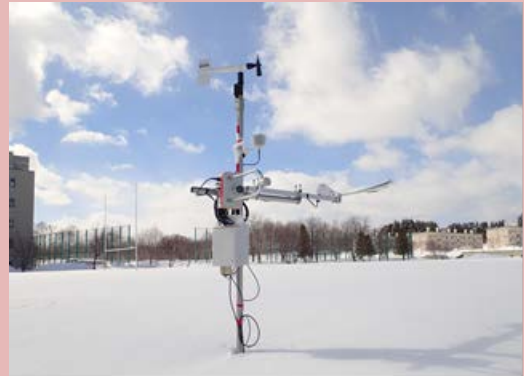
北見工業大学の 400m トラック横に設置した吹雪粒子と視程の観測装置
