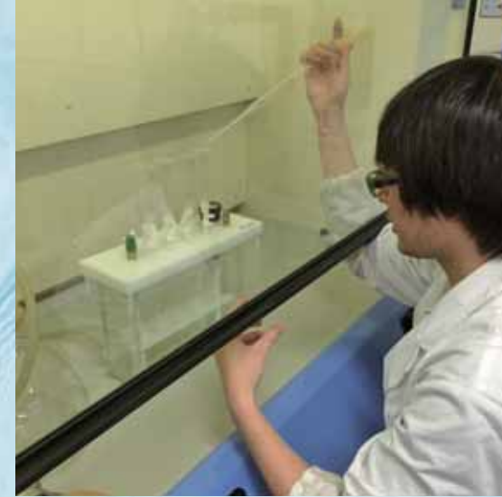
極めて低濃度の物質を分析するため、「固相抽出法」による前処理で対象物質を分離・濃縮する。
