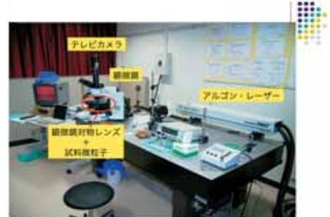
図2 光トラッピングの実験装置
