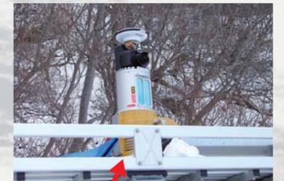
**羽生** ラジコンによる操作に始まり、次は携帯通信による遠隔操作、視覚センサーによる自動制御、GPS誘導による自動制御とシステムのレベルを上げて、そのノウハウを基に除雪支援システムの開発に進みました。開発しているシステムはGPSを利用しますが、カーナビのGPSの誤差が数メートルであるのに対して、このシステムで利用するGPSはRTK-GPSと言って誤差が数センチのものです。これを稼働させるにはGPSの誤差補正情報の取得が必要ですが、知床峠は基本的に携帯電話が通じないため、誤差補正情報の入手が困難です。現地では峠駐車場に独自に誤差補正のためのGPS局を設置して無線で誤差補正情報を供給する必要があります。また、真冬ではシステム運用が大変厳しい状況となります。大学でシステムのコンセプト的な試作を行い、その後民間のソフト会社や最先端のレーザー測量機器を持った企業も参画して、地理データの取得から運用まで一貫して提供できる本格的なシステムが完成しました。やはり本格的なシステムの初期モデルが完成して、知床峠現地での実証試験がうまく行った時は関係者一同深い喜びと達成感を味わいました。
