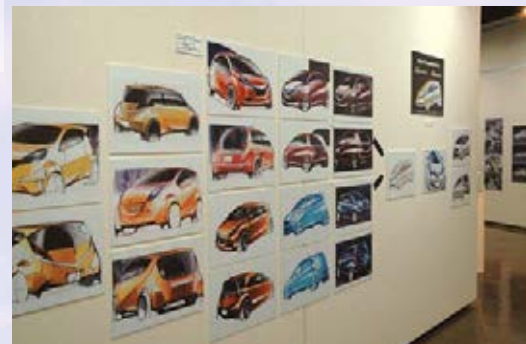
車のエクステリア・デザインが検討されていくステップを展示しました。デザイナーが、企画される車にあったイメージを描き、何通りものアイデア・スケッチに表現します。それらは何段階もの検討を経て、最終的に生産される世の中で使われる車の姿に仕上げられていきます。
