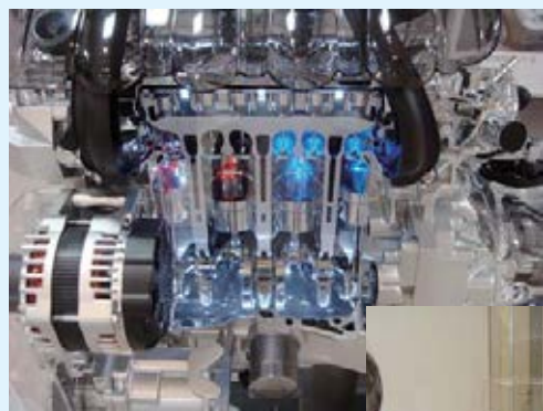
直列 4 気筒エンジン。最新の、コンパクトな1600ccエンジンの動くカットモデルを展示しました。2000ccクラスまでのエンジンでは、この直列4気筒のタイプが世界の主流になっています。
