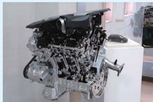
V型 6 気筒エンジン。日本が誇る、「世界のトップ10エンジン」14年連続受賞のエンジンが展示されました。カットモデルなので中の構造も良く分かります。
