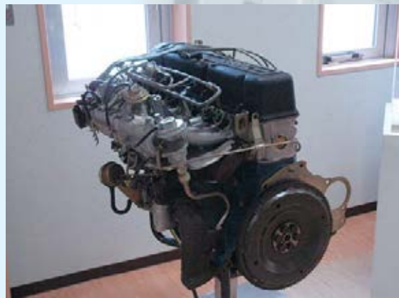
直列 6 気筒エンジン。1982年に誕生した日本で初めてターボチャージャーを搭載したエンジンです。横浜のエンジン博物館からお借りしてきました。
