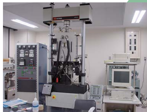
図3 インストロン引張試験機 高温水素中での材料強度を測定することができる。
