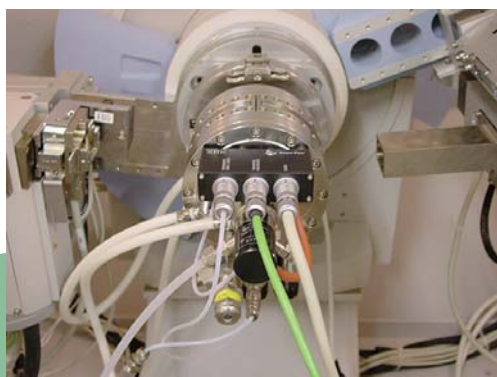
図4 X線回折用リアクターチャンバー。高温高圧水素雰囲気下における材料の構造を測定することができる。
