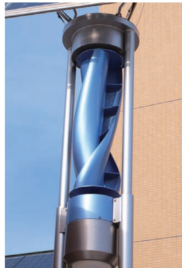
サボニウス風車(風速15m/sで30ワットの出力、知床斜里駅前)
