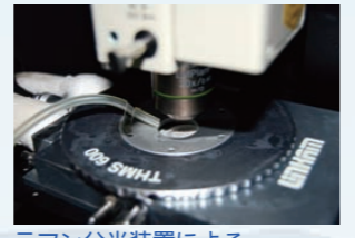
ラマン分光装置によるハイドレート結晶構造の解析
