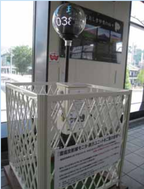
図1 環境放射線モニター。JR甲府駅(山梨県)にて。表示値は0.038μSv/hr。1時間あたりの線量(線量率)をマイクロ・シーベルトで表示している。2階に設置されていて、3階以上がないところなので、主に「宇宙から」の放射線を測っている。
