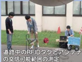
道路中のRFIDタグとアンテナの発信可能範囲の測定
