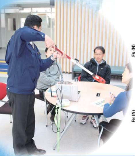
加速度センサーを装着したカーリングブラシと 検出信号の送信機・受信機
