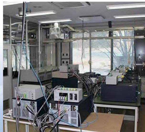
(図1)スマートグリッドシミュレータ
