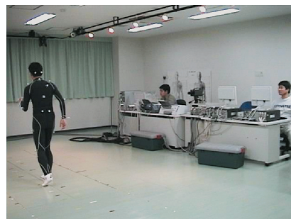
図2 モーションキャプチャによる転倒動作解析および結果例
