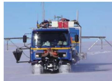
写真2の解説：スウェーデン南極観測隊の雪上車。車体の左右には雪に向かって電波を照射し内部構造を観測するアイスレーダーのアンテナをつけている。
