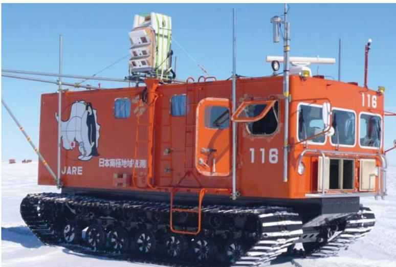
写真1の解説：南極観測隊で使用する雪上車にマイクロ波放射計をつけたところ。雪からの出る電波を観測する。
