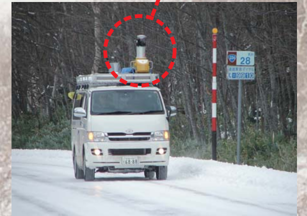
測量用3Dレーザースキャナーを搭載した車による計測の様子
