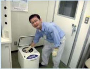
負極材を混練する作業
