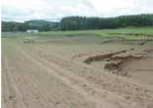
写真2 液状化現象による地盤沈下(2003年十勝沖地震北見市端野町)
