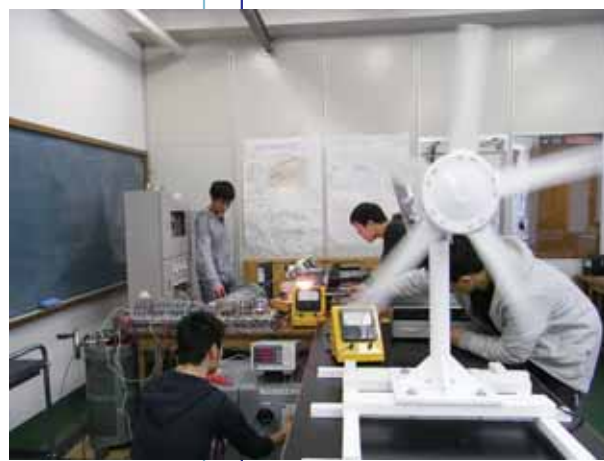
小型風力発電機の発電特性試験の様子
