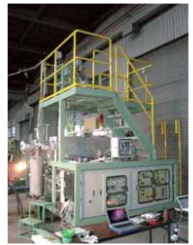
可搬型DMR移動床反応装置 この装置では24m 3 /dayの水素、4kg/dayのカーボンナノチューブの製造が可能
