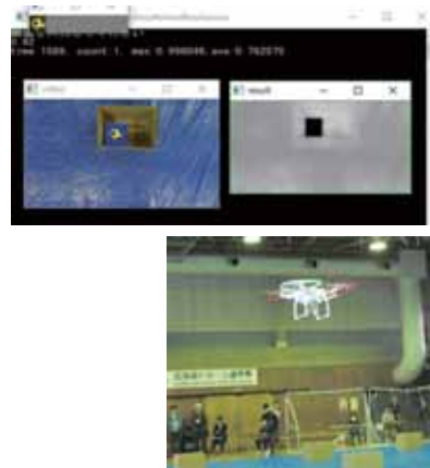
ドローンによる自動計測 （上：計測ソフトウェア、下：計測中のドローン） 決められた動く物体の判別と数について上空から自動計測するシステムの構築を目指している。写真は、サッカーボールを探し出し、その個数を推定する競技（北海道ドローン選手権：9/30開催）に参加した時の様子。
