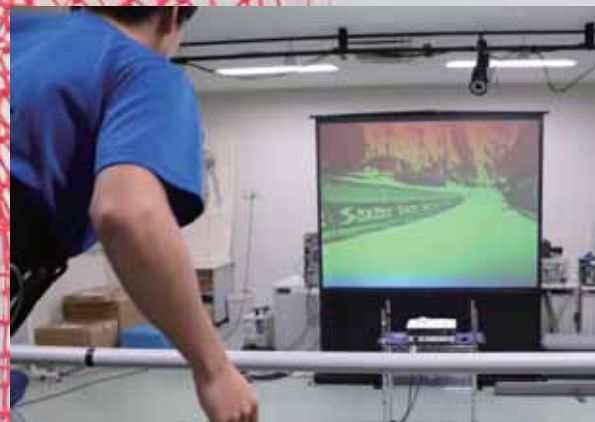
滑降時の内傾角等を瞬時に測定する Sky Tech Sport Ski & Snowboard Simulator での実験の様子
