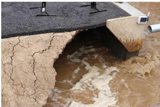
公開実験で再現された、流水により崩れる橋台
