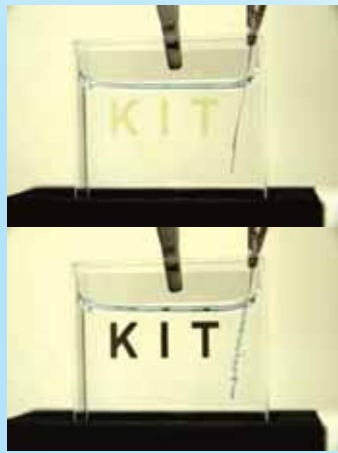
着色させたIr水酸化物薄膜の「KIT」文字 (上)脱色時(可視光透過率が約80%) (下)着色(褐色)時
