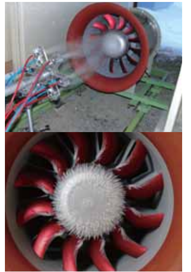
冬期間に屋外で実施した軸流ファン着氷実験の様子。ファンブレードに着氷している。
