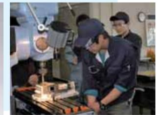
黄銅製ナットの加工作業
