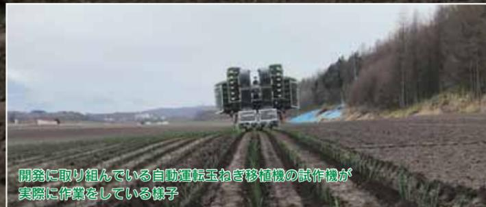
開発に取り組んでいる自動運搬玉ねぎ移植機の試作機が実際に作業をしている様子
