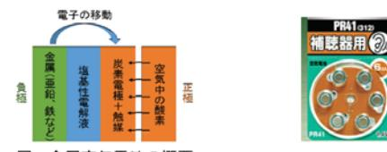
図1: 金属空気電池の概要
