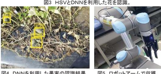
図4 DNNを利用した果実の認識結果。
