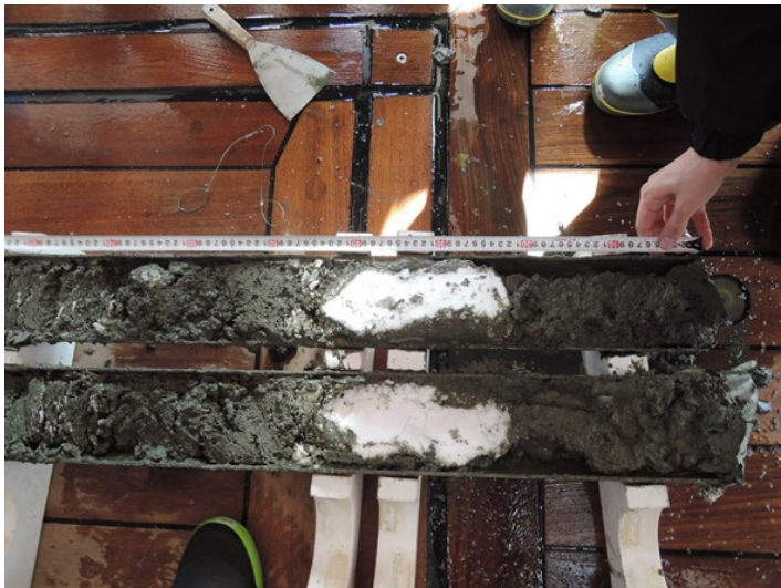
図3 2020年11月の調査で採取された表層型メタンハイドレート塊
