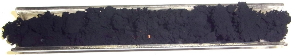
図4 水素生成時に同時に生成されたカーボンナノチューブ塊
