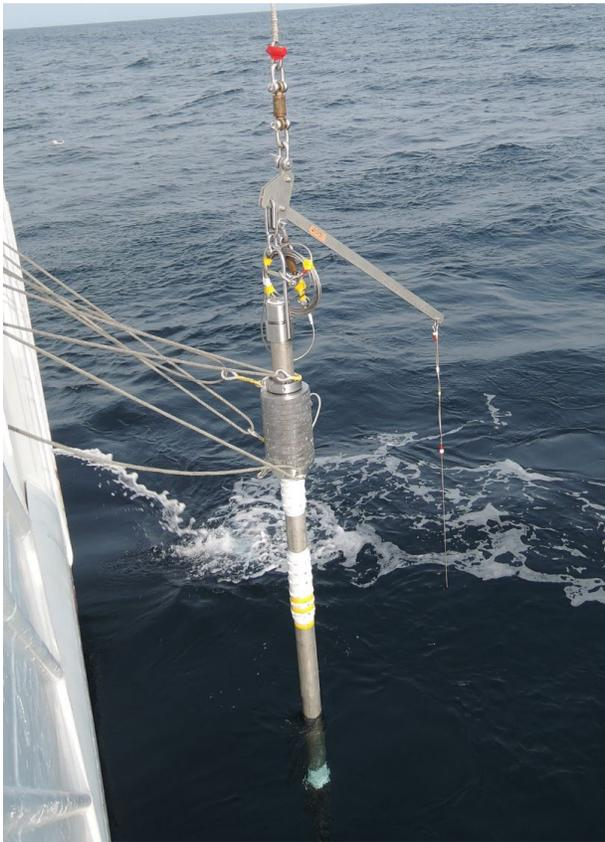
図6 メタンハイドレートの採取に用いた重力式コアラー
