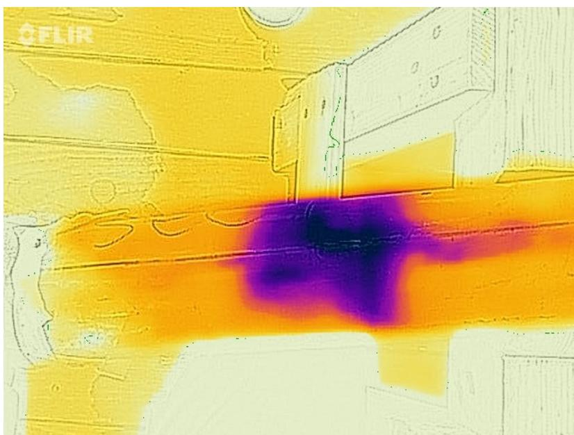
図2 コアラーの内管を分割する前に赤外線カメラで撮影した採取コア
