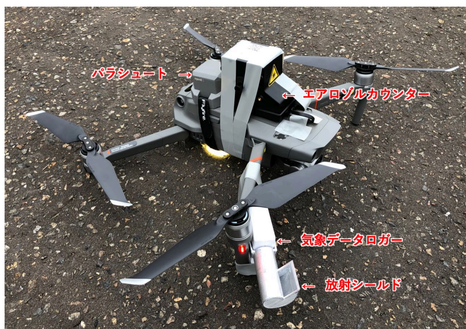
図2：実験に使用した気象センサーを搭載した汎用ドローン (DJI 社製 4枚回転翼機 Mavic 2 Enterprise Dual)。右前アームに気温、気圧、湿度、GPS 位置情報を測定・記録できる気象データロガー (Internet 社製 iMet-XQ2) を取り付け、センサーには本研究で開発した放射シールドを装着。また、頂部にはエアロゾル粒子カウンターとパラシュートを搭載した。(2021年3月25日：北見工業大学オホーツク地域創生研究パークにて；写真撮影：猪上淳)
