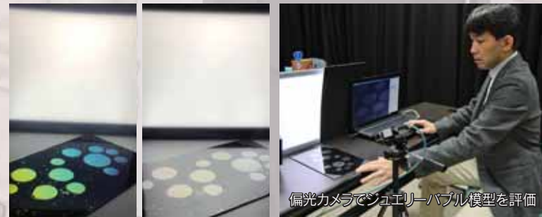
黒アクリル板に、円形に切り抜いた光学用透明粘着シートをのせる(水に相当)。この上に、ポリプロピレンフィルムを貼り付ける(氷に相当)ことで、模型泡(空気)となる部分ができる。この模型に対し、白色LEDバックライトを垂直に配置し、偏光角(56.1°)から観察すると、模型泡の円形部分のみ着色する。
