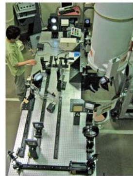
(左) 開発中の補償光学装置。1m×3mの台の上に可変形鏡や波面センサーが配置されている。
