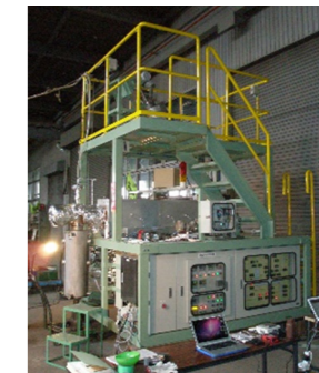
二酸化炭素の発生を伴わない メタン直接水素化反応の実証試験機
