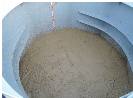
図2：タンク内に製作した模擬地盤
