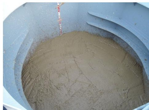
図 2：ポリプロピレンボールと流動化処理土による模擬地盤
