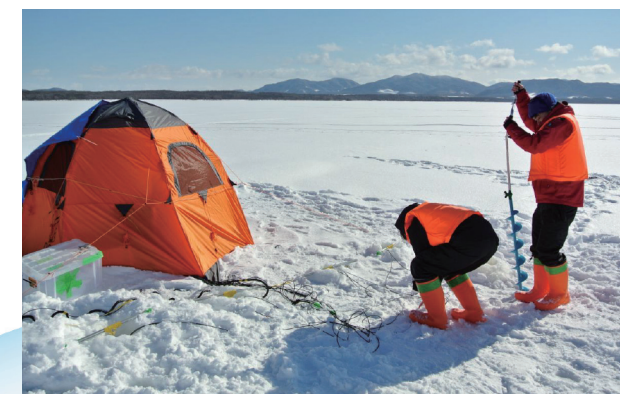
冬季サロマ湖水中音響試験での様子 アイスドリルで氷上に穴を開けてハイドロフォン(水中マイク)を投入している
