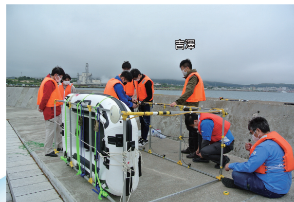
2022年8月北海道紋別市港湾海域での水中音響試験の様子 ゴムボートにGPSアンテナと音波送波器を取り付けて測位精度を評価
