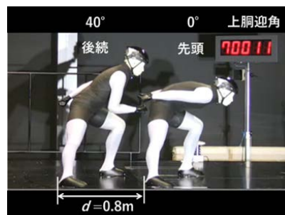
図1 隊列の位置関係と人形模型の姿勢（選手間距離 d=0.8 m、上胸迎角 先頭 0^\circ 後続 40^\circ ）
