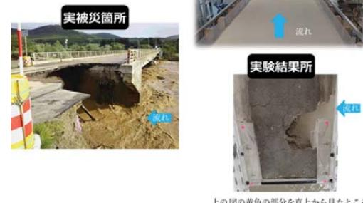
時期により、破堤実験、流路形成過程実験等を行います。洪水の時に橋の道路部分がどのようにして削っていくかについて、対策を考えるための実験をします。
