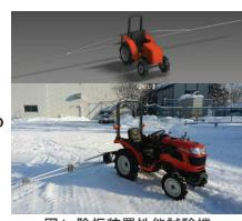
図4 除振装置性能試験機
