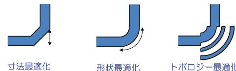
図1 最適化法に基づく設計例
