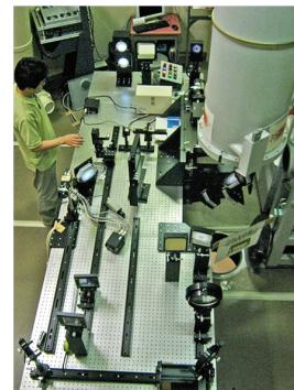
(左)開発中の補償光学装置。1m×3mの台上に可変形鏡や波面センサが配置されている。
