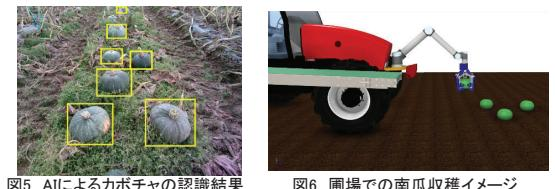
図5 AIによるカボチャの認識結果 図6 圃場での南瓜収穫イメージ
